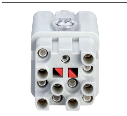
Obr. 1. Trojrozměrný zasunovací profil zvětšuje vzdušné a povrchové cesty
