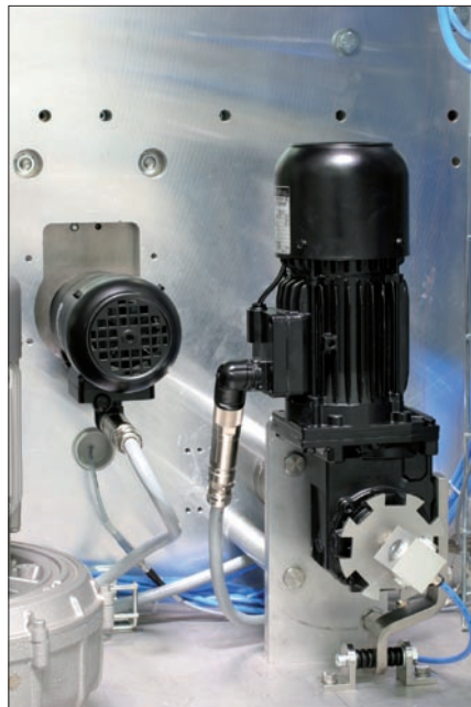
Obr. 2. Dva převodové motory Danfoss Bauer zajišťují optimální pohon cívky a potřebné předepnutí použitého obalového materiálu. Speciální konektory lze otočit do jakékoliv požadované polohy, čímž je podstatnou měrou usnadněno připojení motoru
