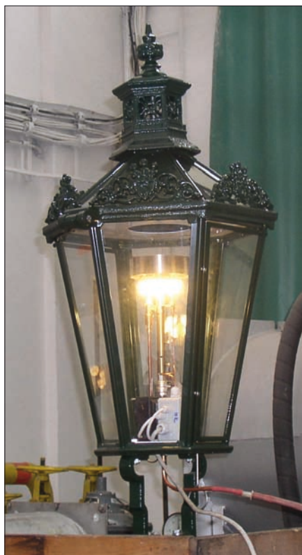
Obr. 5. Lucerna HLP 052 GAS rozsvícená během zkoušek pro certifikaci
