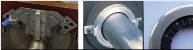
Obr. 7. Klasický uzemňovací kartáč (vlevo) a uzemňovací kartáč tvořený vodivými mikrovlákny (vpravo)
