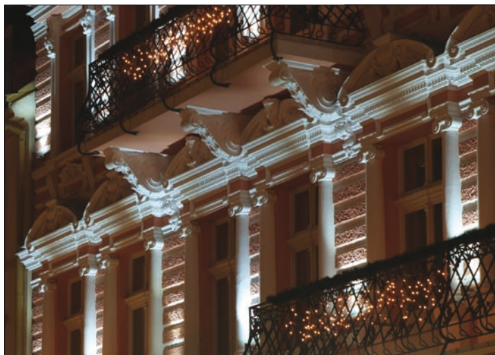
Obr. 3. Jednoznačně definované rozložení svítivosti zdůrazňuje řešení fasády a neobtěžuje hosty nechtěným světlem
