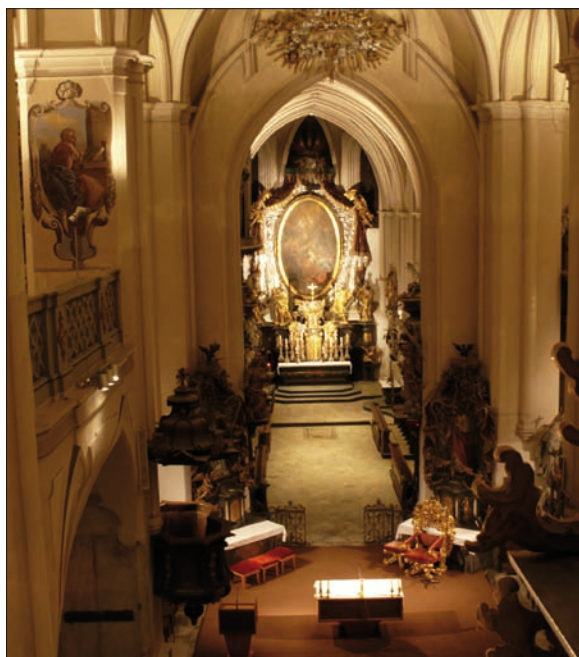
Obr. 4. Některé části chrámového prostoru jsou zdůrazněny směrovým osvětlením; směrová svítidla Tecnica pro osvětlení prostoru lavic jsou umístěna v tříokruhové napájecí liště připevněné na římsě zábradlí na ochozu
