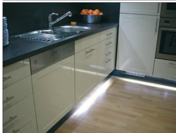
Obr. 7. Systém pro montáž do nábytku Twin Stick (dvojitá tyčka) obsahuje dvě řady světelných diod osazených technikou povrchové montáže na pásy o délkách 200 nebo 300 mm a množství doplňujících částí. Uspořádání zajistí rovnoměrné rozložení světelného toku, tón barvy lze volit studeně bílý a teple bílý. Na obrázku je příklad použití v kuchyňském nábytku
