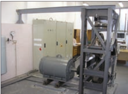
Obr. 7. Zkušební pracoviště se synchronním trakčním motorem a asynchronním zatěžovacím strojem
