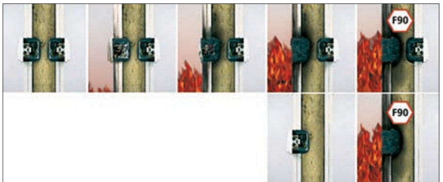
Obr. 8. Způsob funkce krabic pro duté stěny HWD 90
