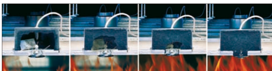
Obr. 4. Prostředek pro vytváření izolační vrstvy v krytech FlamoX
