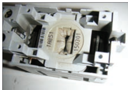
Obr. 2. Pohled do otevřeného stykače s viditelným vytečením izolační hmoty
