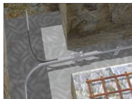
Obr. 4. Vývod pro připojení svodu opatřený izolací
