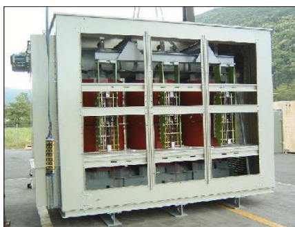
Obr. 2. Lodní transformátor 12 MV·A, 22/6,2 kV s výměníkem tepla vzduch-voda a s přepínačem odboček pod zatížením
