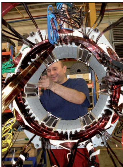
Obr. 3. Upevňování cívek do drážek statoru
