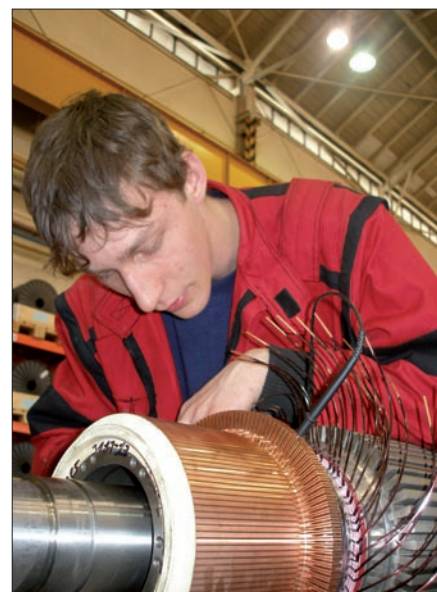
Obr. 4. Práce na rotoru – připojování vývodů cívek ke komutátoru
