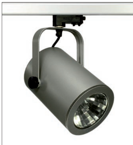
Obr. 1. Přípojnícové svítidlo Cyli-Con výrobce: finská firma Lival obj. číslo: LI 16722335 provedení: hliník světelný zdroj: halogenidová výbojka HCI-T 70 W/NDL s patičí G12 rozměry: 212 × 189 × 330 mm dodáváno bez světelných zdrojů cena bez DPH: 5 160 Kč
