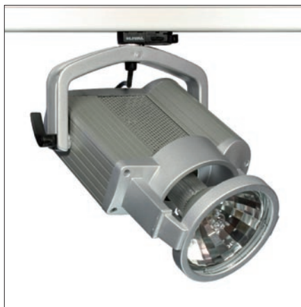
Obr. 2. Přípojnícové svítidlo Hawk výrobce: finská firma Lival obj. číslo: LI 19422335 provedení: hliník a termoplast světelný zdroj: halogenidová výbojka HCI-T 150 W/NDL s patičí G12 rozměry: 305 × 277 × 375 mm dodáváno bez světelných zdrojů cena bez DPH: 5 072 Kč
