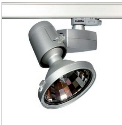
Obr. 4. Přípojnícové svítidlo Shop-Master výrobce: finská firma Lival obj. číslo: LI 12825335 provedení: termoplast světelný zdroj: halogenidová výbojka HCI-T 70 W/NDL s patičí G12 rozměry: 258 × 181 × 168 mm dodáváno bez světelných zdrojů cena bez DPH: 5 859 Kč
