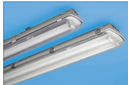
Obr. 3. Svítidlo Prima pro závěsné výšky nad 6 m (k dosažení optimálních parametrů osvětlení je doplněno parabolickým reflektorem z leštěného hliníku)
