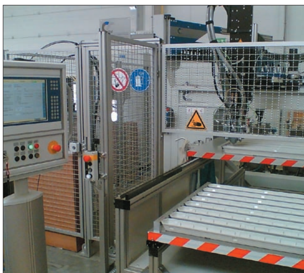
Obr. 2. Linka pro vypěňování těsnění
