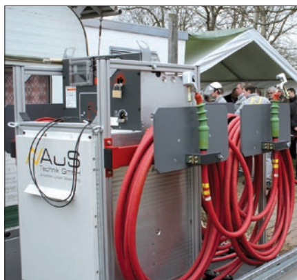
Obr. 1. Mobilní spínačová přemostovací jednotka
