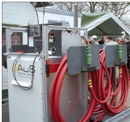
Obr. 1. Mobilní spínací přemostovací jednotka
