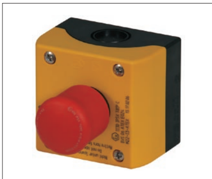
Obr. 2. Větší uplatnění v průmyslových aplikacích nachází tlačítka nouzového zastavení ze sortimentu RMQ-Titan (montážní otvor 22 mm); jsou k dispozici jako prosvětlená či bez prosvětlení, s ovládáním klíčem, s odaretací pootočením či povytažením
