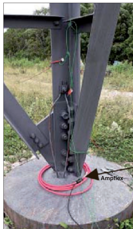
Obr. 6. Připojení sondy Ampflex k patě stožáru
