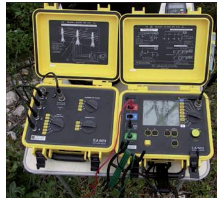
Obr. 3. Test zemničů stožárů vvn přístroji CA 6472 (vpravo) a CA 6474
