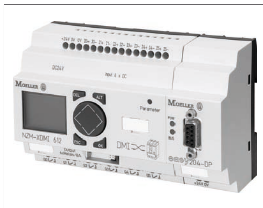
Obr. 4. Data uložená v jističi lze získat také prostřednictvím modulu DMI
