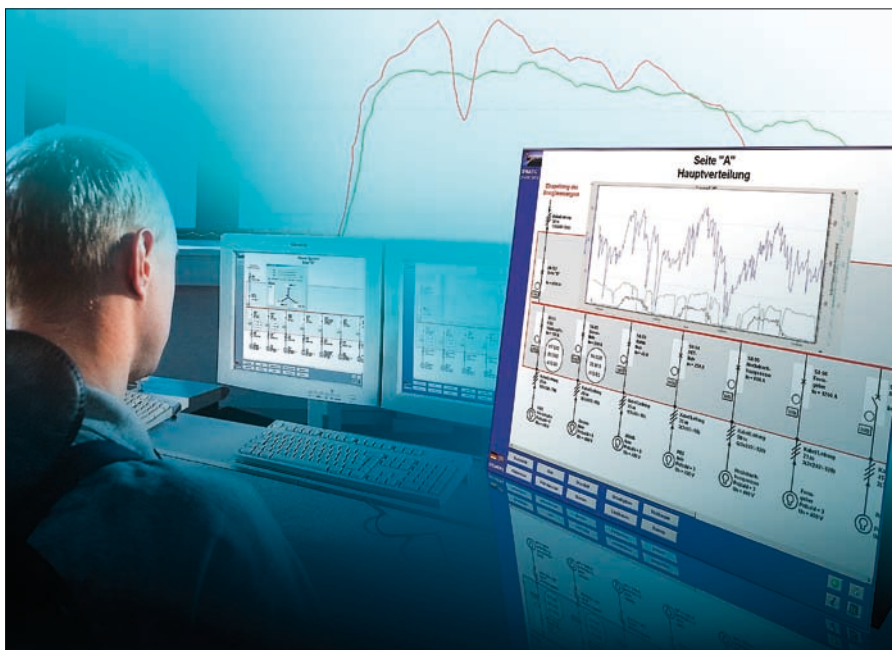
Obr. 1. Simatic powercontrol – centrální náhled na toky všech energií
