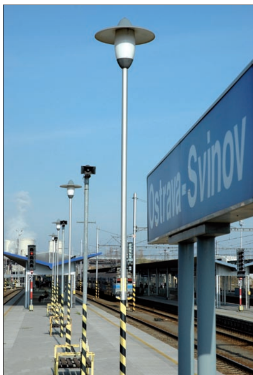
Obr. 1. Nekryté části nástupiště jsou osvětleny svítidly Mexico 70 W
