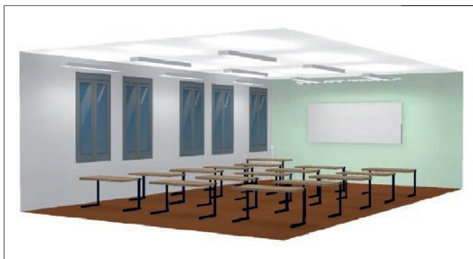
Obr. 4. Návrh osvětlení učebny se svítidly Siluette (5 svítidel 2x 80 W, 3 svítidla 1x 49 W a 1 svítidlo 2x 49 W) a Comfolight (2 svítidla 1x 49 W)
