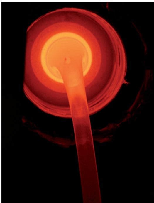
Obr. 2. Proud skla vytékající z tavicí pece
