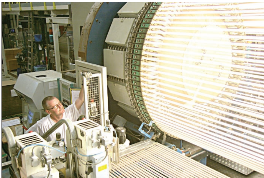
Obr. 4. Zaměstnanec výrobní linky dohlíží na proces testování hotových zářivek
