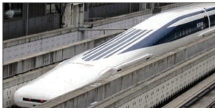
Obr. 16. Japonský superexpres MLX01; klínový tvar kapoty předního vozu výrazně snižuje aerodynamický odpor
