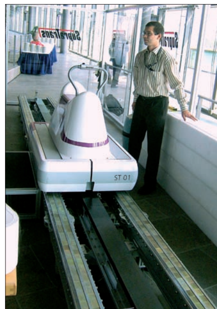
Obr. 21. Funkční model vozidla Supra Trans
