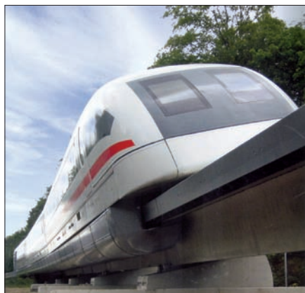
Obr. 11. Uložení Transrapidu na drážním tělese
