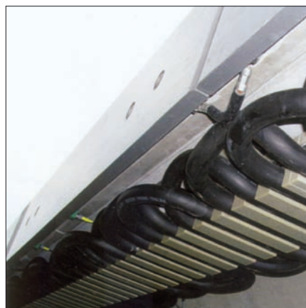
Obr. 5. Pohled na „dlouhý stator“ Transrapidu, uložený vespod jízdní dráhy
