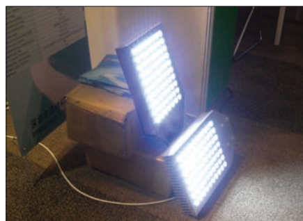
Obr. 5. Uliční svítidlo osazené diodami LED v žebrovaném hliníkovém krytu – celkový elektrický příkon 125 W, světelný tok 9 100 lm, krytí IP65; určeno k upevnění ve výšce 10 až 14 m (výrobce ONTEK, Čína)
