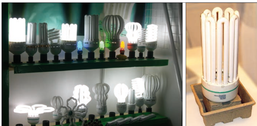
Obr. 3. Výstavní sada kompaktních zářivek – v detailu je zářivka s parametry 200 W, 220 V AC, 960 mA, 6 400 K, PF > 0,95, 12 000 lm; katalog uvádí i typ o výkonu 250 W se světelným tokem 14 850 lm
