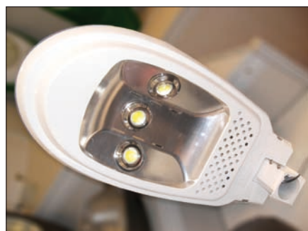
Obr. 6. Vnitřek uličního svítidla se třemi skupinovými zdroji LED – příkon každé skupiny 30 W, příkon svítidla 90 W
