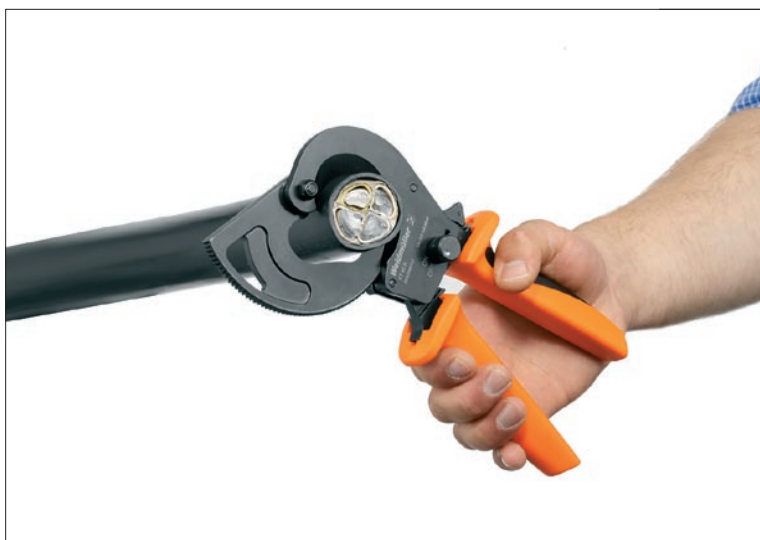
Obr. 2. Stříhání kabelu kleštěmi KT 45R
