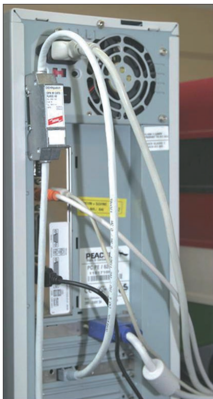
Obr. 8. DEHNpatch, propojovací tzv. patch kabel s přepětovou ochranou
