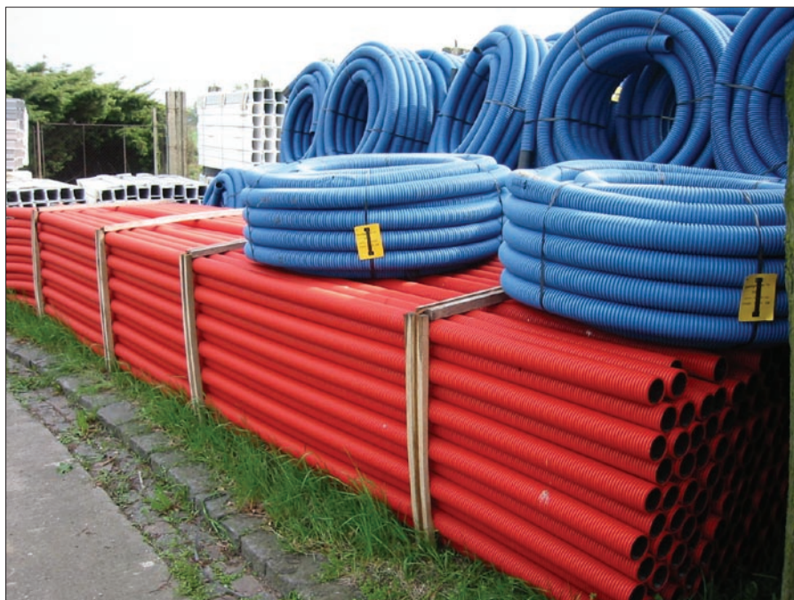
Obr. 2. Standardní barvou korugovaných trubek je červená (na přání zákazníka jsou k dodání i jiné barevné odstíny)
