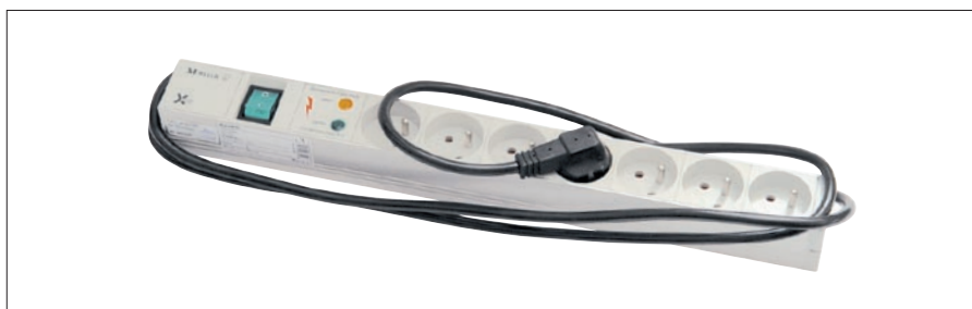
Obr. 4. 19" napájecí panel se svodičem přepětí třídy III (D)
