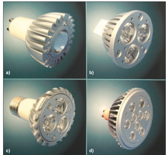
Obr. 9. Světelné zdroje na bázi LED, vyráběné pro barvu světla bílou, teplou bílou, modrou, zelenou, červenou, žlutou nebo RGB a) patice GU10, napětí 85 až 260 V, příkon 3 nebo 5 W b) patice 2 pin G5.3, napětí 12 V, příkon 3 W c) patice E27, napětí 85 až 260 V, příkon 6 W d) patice GU10, napětí 85 až 260 V, příkon 9 W
