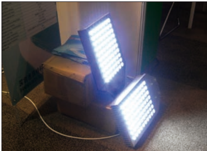
Obr. 6. Uliční svítidlo osazené LED v žebrovaném hliníkovém krytu; celkový elektrický příkon 125 W, světelný tok 9 100 lm, teplota chromatičnosti 5 000 až 7 000 K, určeno k upevnění ve výšce 10 až 14 m, krytí IP65 (výrobce ONTEK, Čína)
