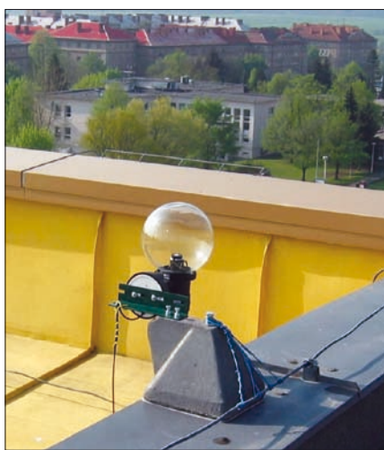
Obr. 1. Měřicí aparatura pro dlouhodobá měření osvětlenosti pod noční oblohou
