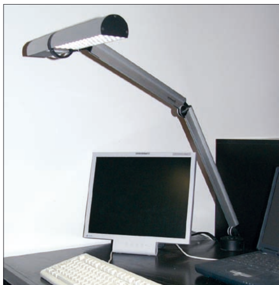
Obr. 7. Waldmann Lichttechnik – DIVA PTE 111, design F. A. Porsche, dvoudílné nastavitelné kloubové rameno, upínací svorka, vlastní optická část s otočným stínidlem, barva svítidla stříbrná, upínací svorka černá, kompaktní zářivka Dulux - S/E, 11 W s patičkou 2G7 ve válcovém reflektoru cloněná parabolickou zrcadlovou mřížkou a napájená elektronickým předřadníkem, hmotnost 3,04 kg, cena včetně DPH od 9 100 Kč (foto Ing. J. Kotková)
