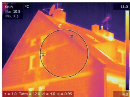
Obr. 1. Ukázka termovizního snímku budovy (světlé body označují úniky tepla)
