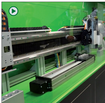
Obr. 3. Demonstrační verze polohovacího systému sestaveného z produktů brněnské HIWIN, s. r. o.
