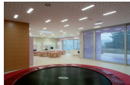
Obr. 4. Do prostorů, kde děti ve školce Za Branou tráví nejvíce času, se denní světlo dostává nejen okny, ale i několika světlíky. Rovnoměrné teplo na tak velké ploše zajišťuje jediné podlahové topení. Výměna vzduchu aerostaty ve stropě je dnes nejen nutností, ale v novostavbách snad už i samozřejmostí.
