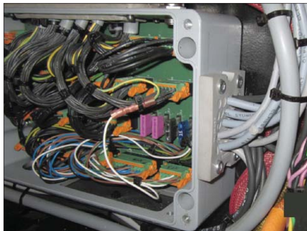
Obr. 2. Příklad použití průchodky KEL-DPZ
