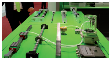
Obr. 2. Ukázky lineární techniky HIWIN. V zadní části panelu jsou vodič tyče s kuličkovými pouzdry, v popředí zleva: kolejnice s vozíkem, kuličkový šroub s maticí, ozubený hřeb s pastorkem
