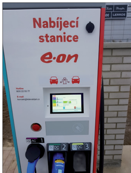
Obr. 2. Dobíjecí stanice je připravena na různé typy konektorů
