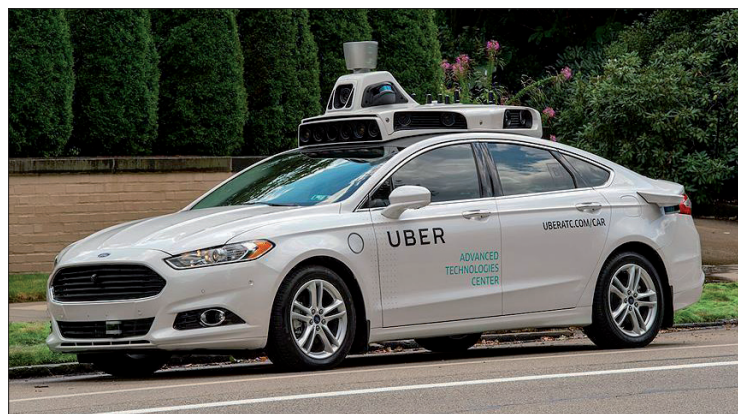
Obr. 2. Prototypové vozidlo taxislužby se sadou senzorů podporující stupeň 5
