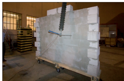
Obr. 8. Realizácia experimentu, meranie prierného napätia ytong izoláčny materiál – 2. fáza experimentov
