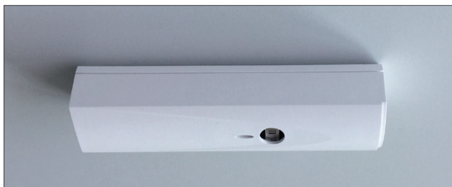
Obr. 1. Modul C-IF-6400R je dodáván v plastovém pouzdru s možností montáže např. na strop jako čidlo přítomnosti osob pod ním; ze zpracování matice bodů aplikačním programem lze odvodit mnoho informací: např. o přítomnosti osoby, směru jejího odchodu či příchodu, počítání osob se směrem jejich příchodu i odchodu
