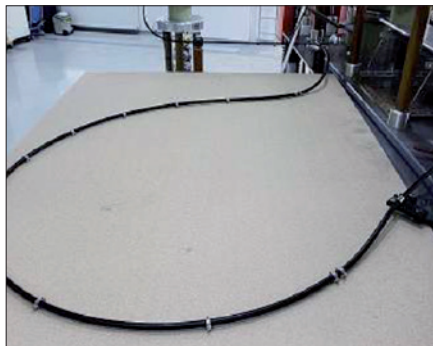
Obr. 10. Uspořádání pro zkoušku propustnosti pro bleskový proud izolovaného svodu
