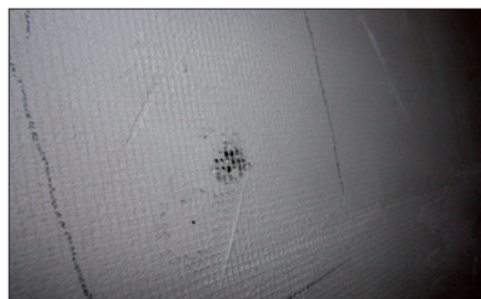
Obr. 7. Realizácia experimentu, meranie prierného napätia ytong + polystyrén (priern + tavenie polystyrénu)
