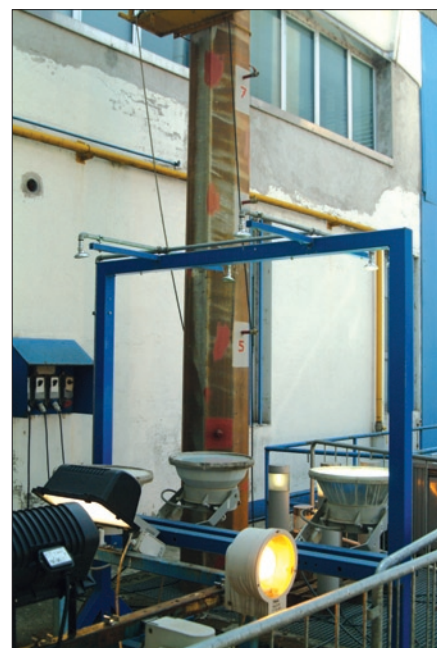
Obr. 3. Sloup a sprchy na testování elektrického krytí IP – SBP
