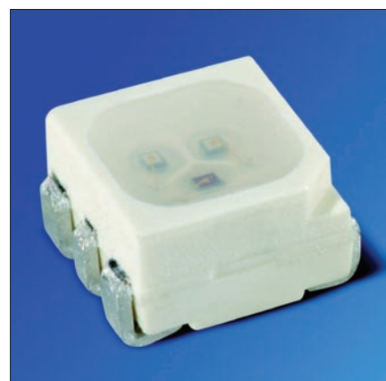
Obr. 6. Patentově chráněný prvek 6-lead Multi-let pro podsvětlení displeje střední velikosti
