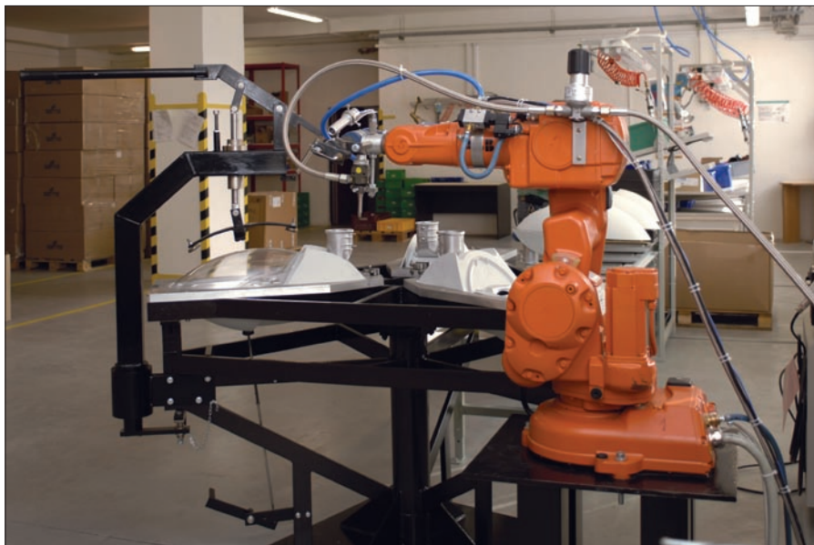
Obr. 4. Konečná operace, montáž průhledného krytu svítidla
