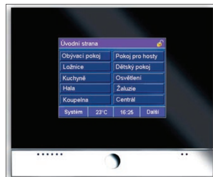
Obr. 3. Možné zobrazení úvodní strany dotykového displeje
