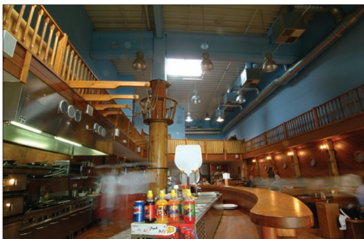
Obr. 1. Pizzeria Ristorante Bonnacina osvětlená závěsnými svítidly Box Lama 33, osazenými halogenidovými výbojkami 250 W
