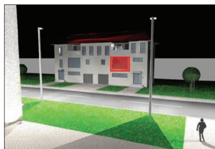
Obr. 3. Výpočtová rovina svislé osvětlenosti v rovině oken obytné budovy
