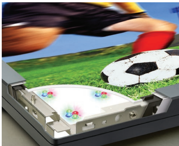
Obr. 3. Podsvětlení displeje bloky RGGB-Cluster s diodami typu Golden Dragon Argus
