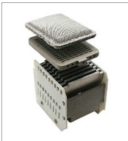
Obr. 2. Zhášecí komora jističe Compact NS s kovovým filtrem
