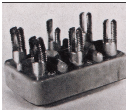
Obr. 5. Svorkovnice DIN 46295 se značně zdeformovanými a poškozenými mosaznými šrouby s drážkou
