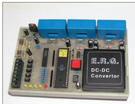
Obr. 2. Modul pro vyhodnocování efektivní hodnoty nesinusových proudů elektrického pohonu s mikrokontrolérem AT 89S8252 (klon řady 8051 od firmy Atmel) a externím A/D převodníkem vyvinutý v ústavu přístrojové a řídicí techniky ČVUT v Praze, Fakulta strojí
