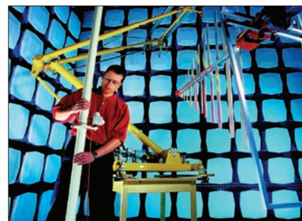
Obr. 2. Komora pro zkoušky EMC
