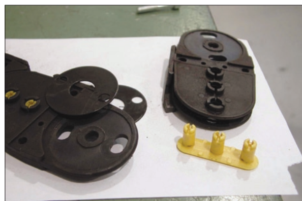
Obr. 3. Detail nylonových protiprachových kluzných disků
