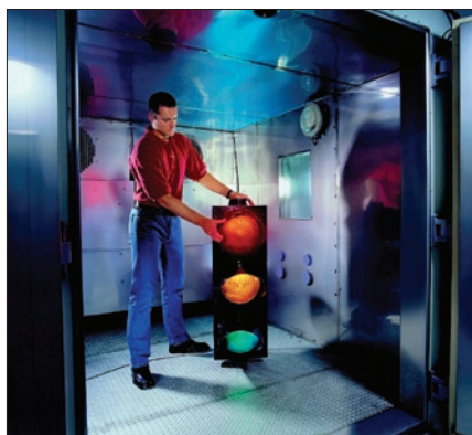
Obr. 4. Příprava zkoušky návěstidel v klimatické komoře
