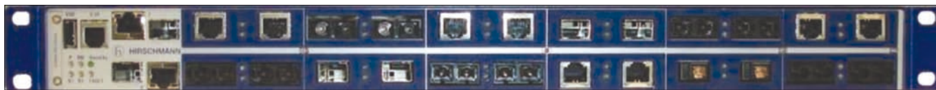
Obr. 1. Příklad Mach 1 030 s porty 8× FE fiber SC MM/SM, 8× FE RJ45, 4× FE SFP slot, 2× FE ST MM/SM, 2× FE MTRJ MM/SM, 2× GE Combo (2×RJ45/SFP slot)
