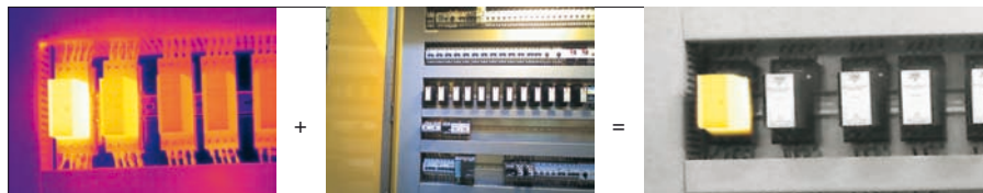
Obr. 3. Funkce Thermal Fusion umožňuje prolínání termovizního a reálného obrazu
