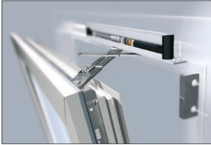
Obr. 3. Pohony v horním dílu okenního rámu oddaluje dvojicí zkřížených pák hranu okna od rámu. Pro zázorněnou aplikaci se mohou použít pohony Maxon s novými lineárními převodovkami s průměry 22 a 32 mm.
