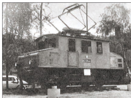
Obr. 8. Českou elektrickou lokomotivu, stroj E 225.001 „koloběžka“, vyrobil František Křižík v roce 1905 pro pouliční dráhu ve Vídni; měla velmi silný tah, ale vzhledem k malé adhezní hmotnosti (29t) pomalý rozjezd. Do ČSR byla navržena v roce 1918; v roce 1925 byla upravena na 1 500 V DC a určena k posunům vlaků
