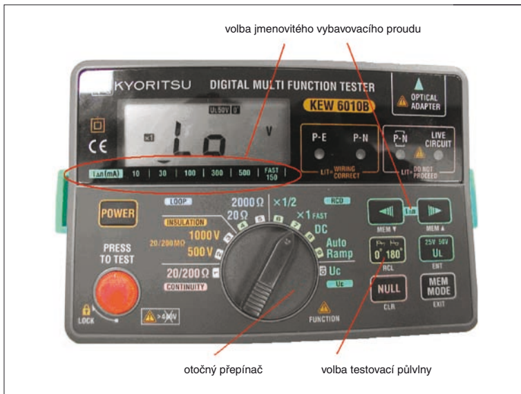
Obr. 4. Ovládání KEW 6010B při testu proudových chráničů
