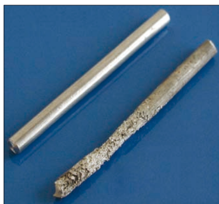
Obr. 2. Nový drát AlMgSi (vlevo nahoře), drát AlMgSi poškozený chemickou reakcí s fasádou po čtyřech měsících (vpravo dole)
