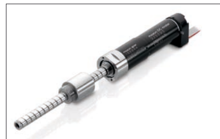
Obr. 2. Lineární planetová převodovka se šroubem. Hřídel se šroubem je podepřena axiálním ložiskem v zesílené hlavě. Převodovka je poháněna motorem DC s inkrementálním snímačem.
