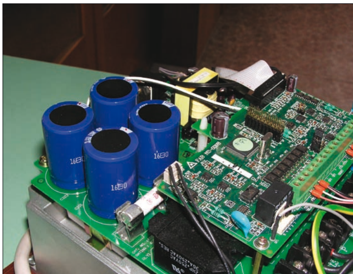
Obr. 7. Řídicí jednotka s DSP v sériově vyráběném měnič frekvence pro průmyslové pohony
