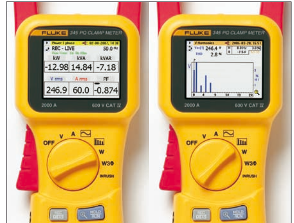
Obr. 2. Displej přístroje při měření výkonů (vlevo) a harmonických (vpravo)
