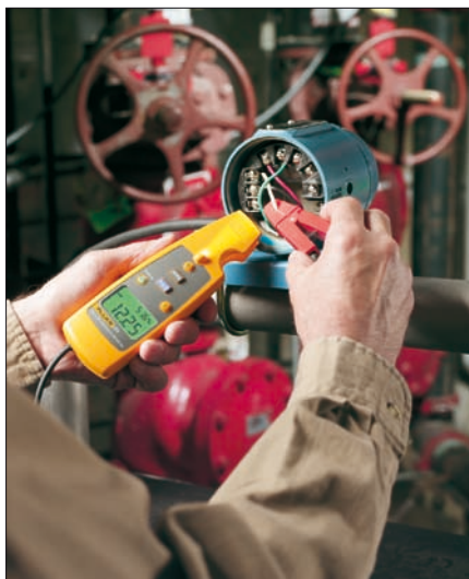
Obr. 3. Měření s vytaženým klešťovým přístrojem
