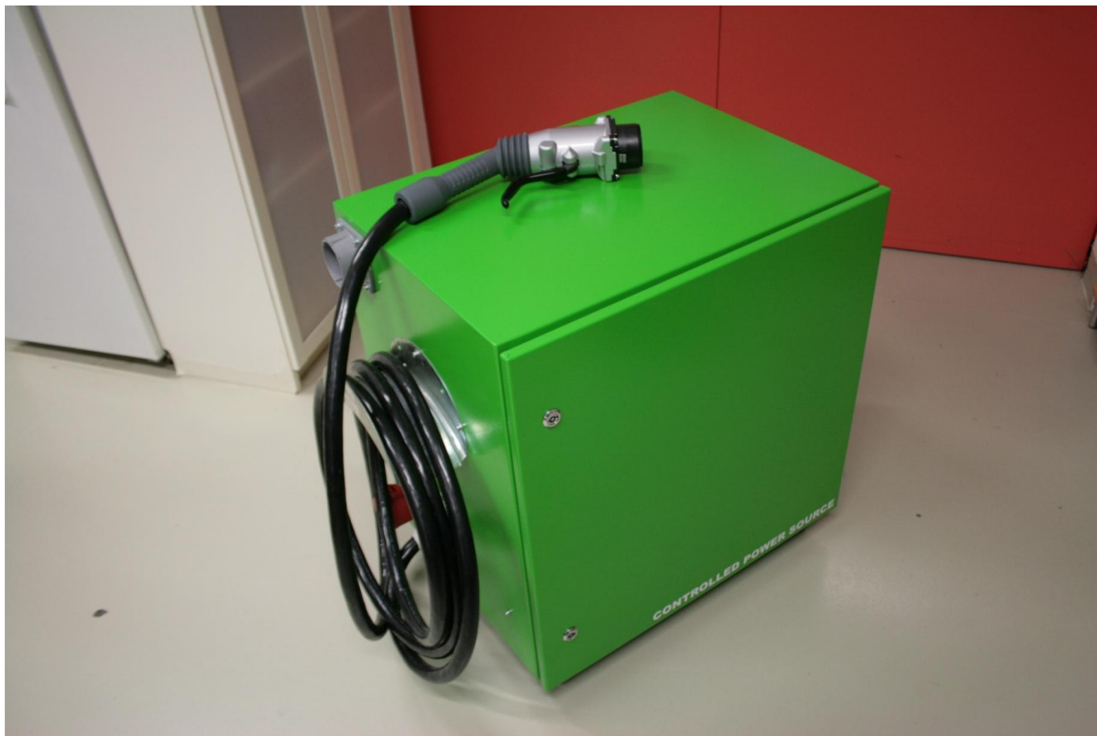
Modul „MZE“ s připojovacím kabelem nabíjení/vybíjení elektromobilu s koncovkou CHAdeMo Yazaki 400V/125A (2015)
