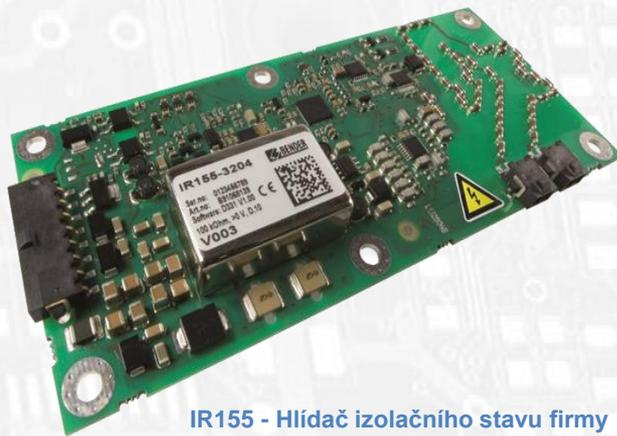
IR155 - Hlídač izolačního stavu firmy Bender pro elektrická vozidla
