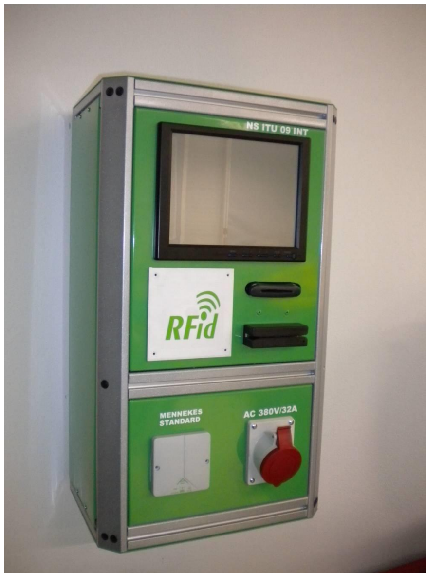
Obr. 31 Nástěnná nabíjecí stanice s tarifikací odebrané elektrické energie v prototypové laboratoři CPIT C112 (2009).
