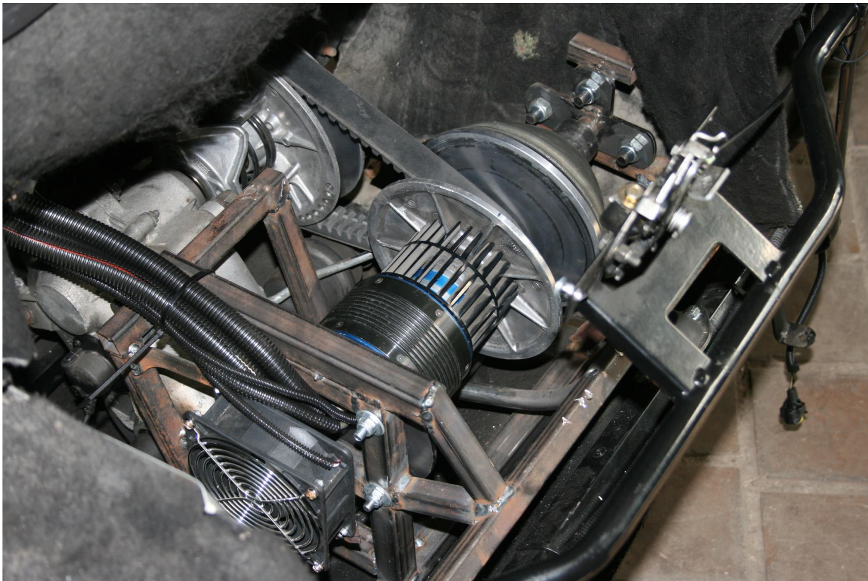
Obr. 23 Realizace BLDC pohonu pro demonstrační účely do chassis AIXAM, řídicí elektronika MGM Compro, 2011)
