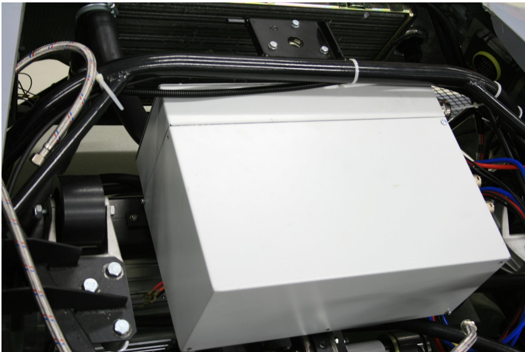
Obr. 26 Zástavba duálního frekvenčního měniče II. generace do chassis K0, řešení elektronického diferenciálu a synchronizace duálních pohonů (2011/2012)
