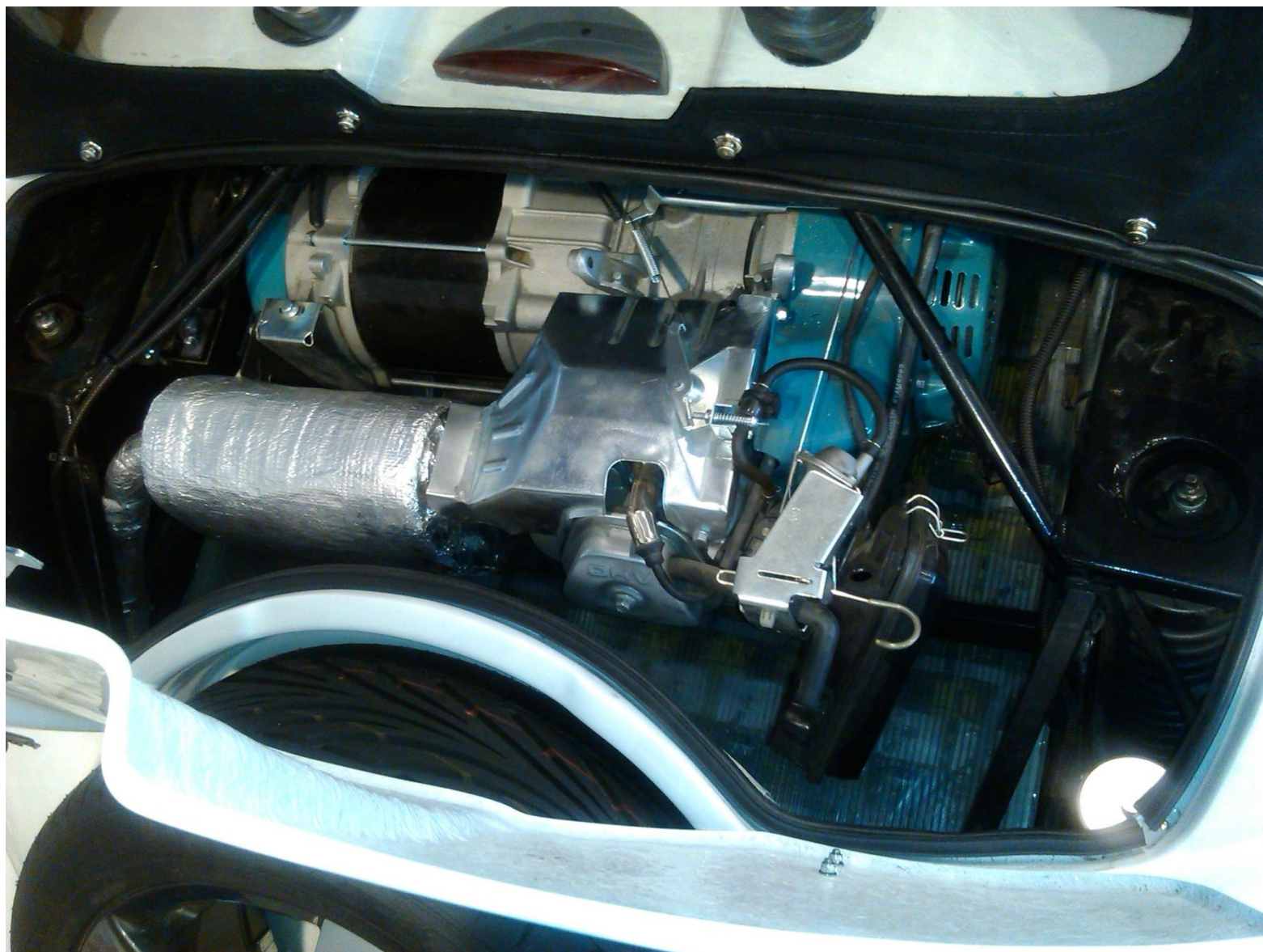
Obr. 43 Finální zástavba RE I.generace do zádí K2 (2011)
