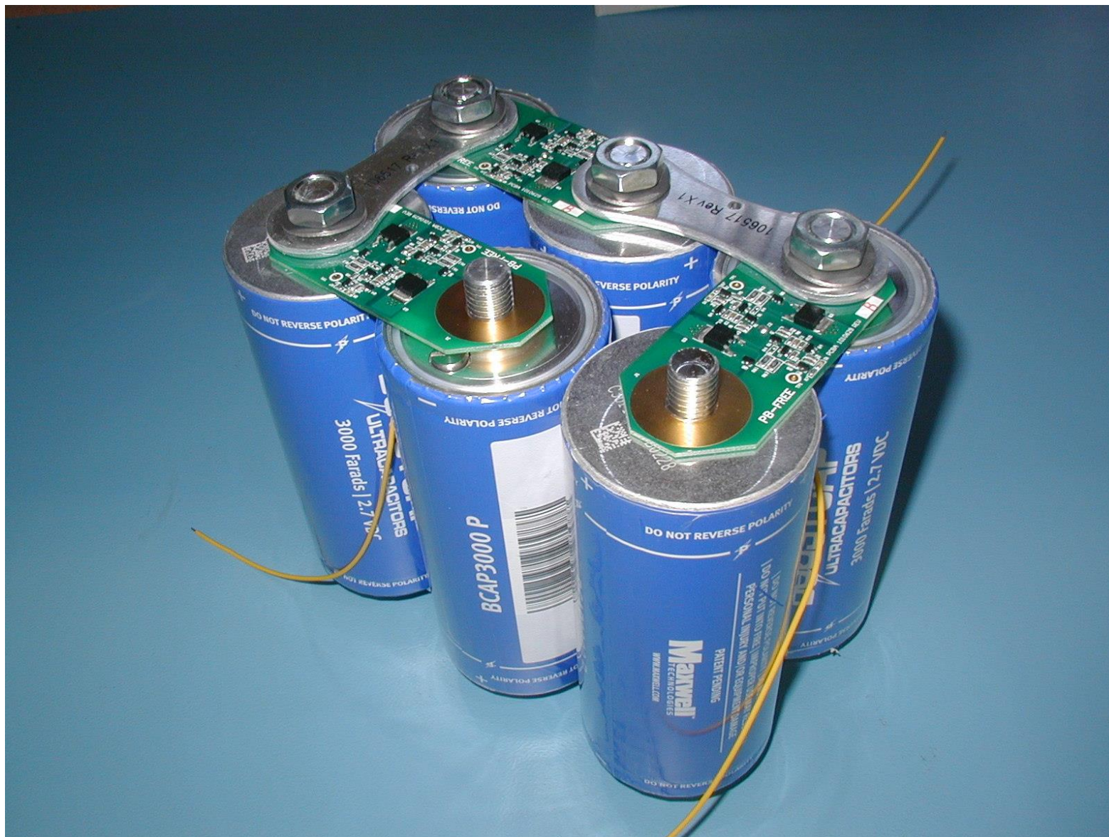
Obr. 46 Experimentální soustava superkapacitorů pro palubní zdroj K3 12V (2012)
