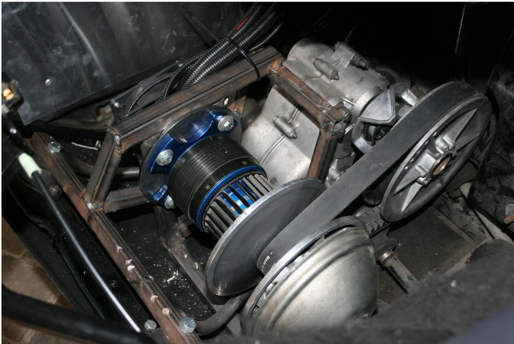
Obr. 24 Realizace BLDC pohonu pro demonstrační účely do chassis AIXAM, řídicí elektronika MGM Compro, 2011)
