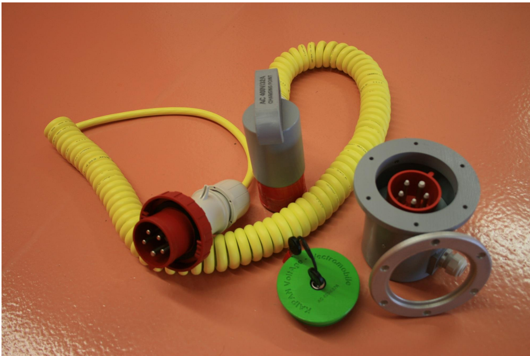
Obr. 36 Nabíjecí kabel a integrovaná nabíjecí zásuvka pro K0-K2 (2009-2011).
