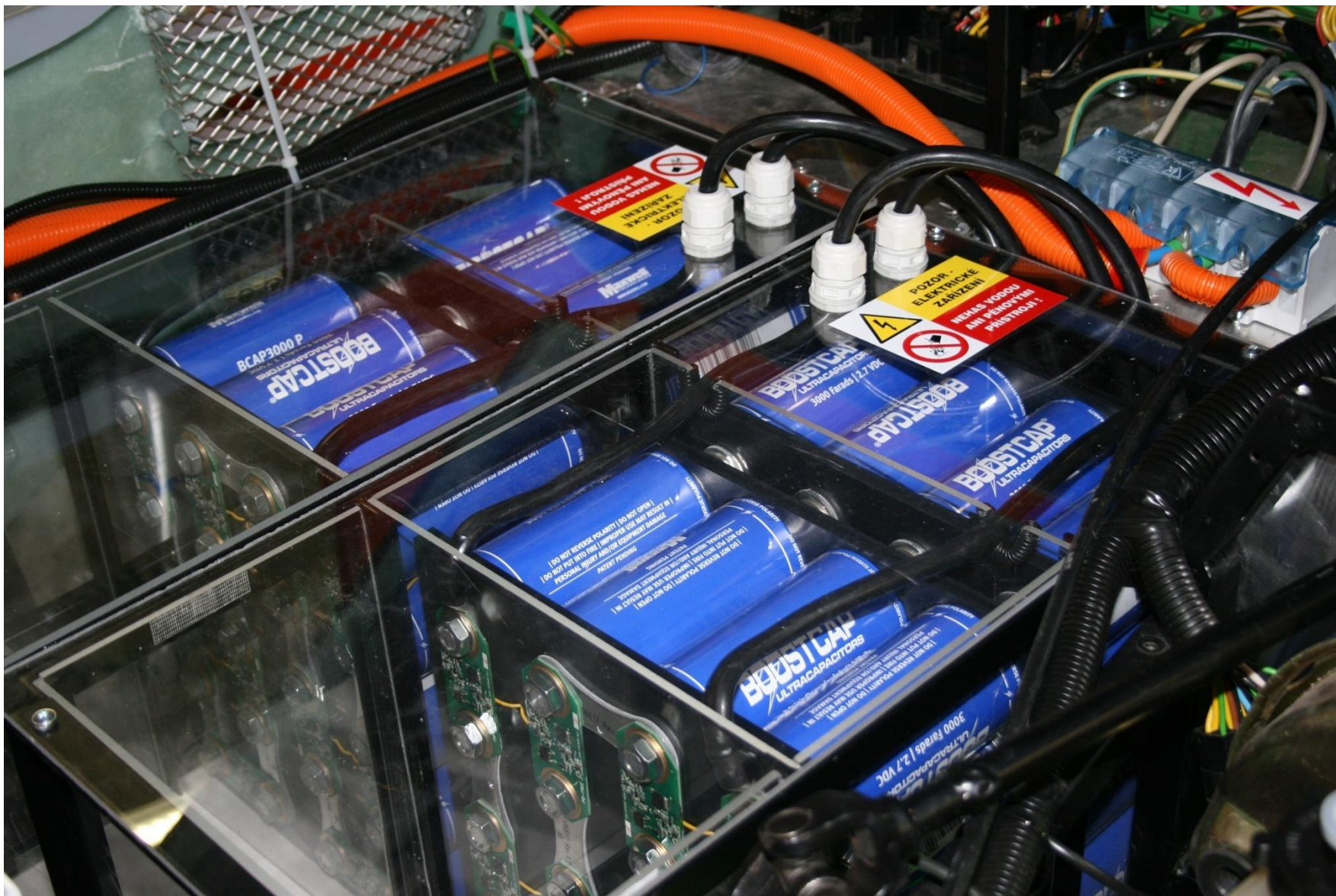
Obr. 48 Experimentální soustava superkapacitorů pro palubní zdroj 106V vestavěná do přední zdrojové části K3 (2012/2013)
