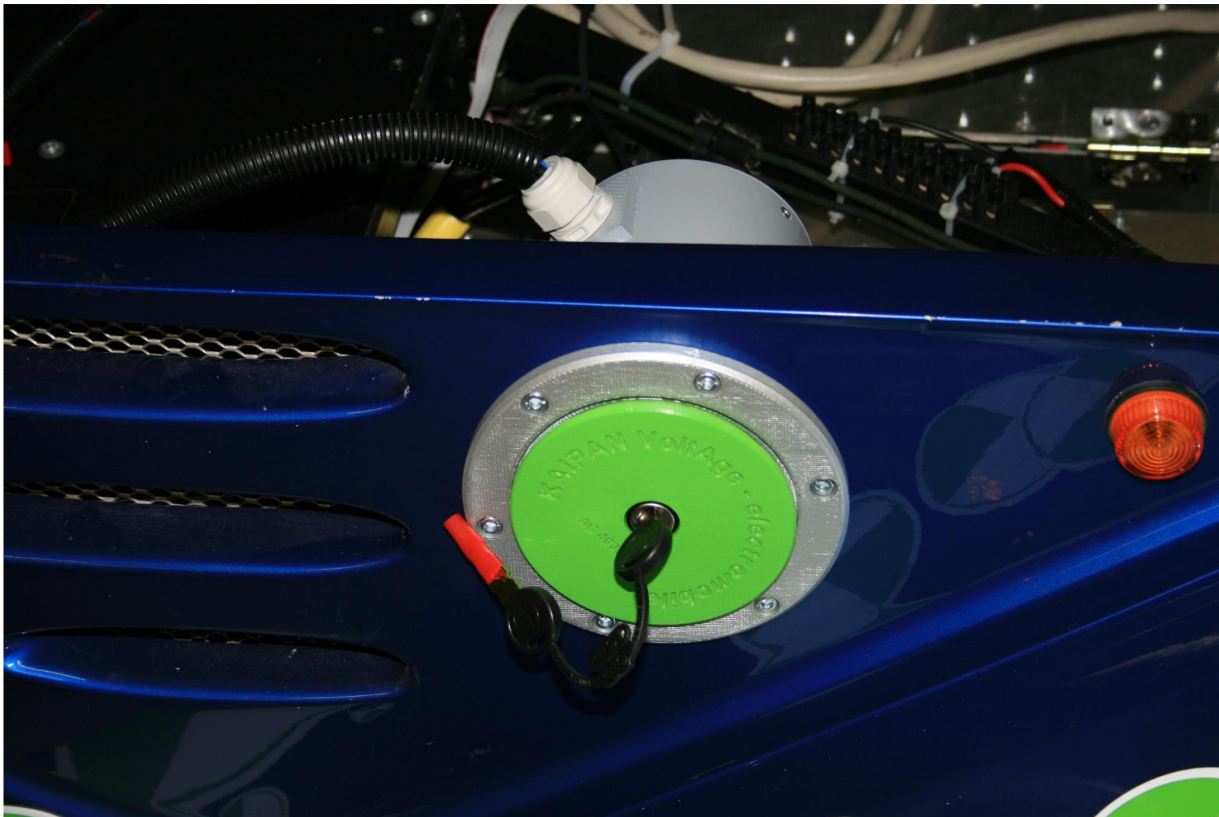
Obr. 37 Zástavba nabíjecí zásuvky do K0 (2009) následně i do K1 a K2.
