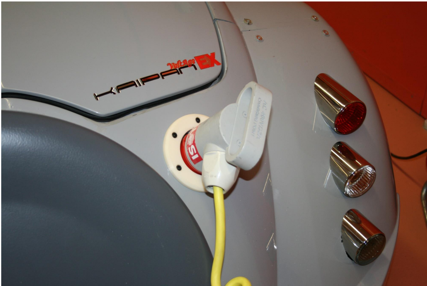
Obr. 38 Energetický slot prototypu K3 (MFS – záměnný slot pro Mennekes, CNG a H2 nabíjecí/plnicí koncovku, 2012).
