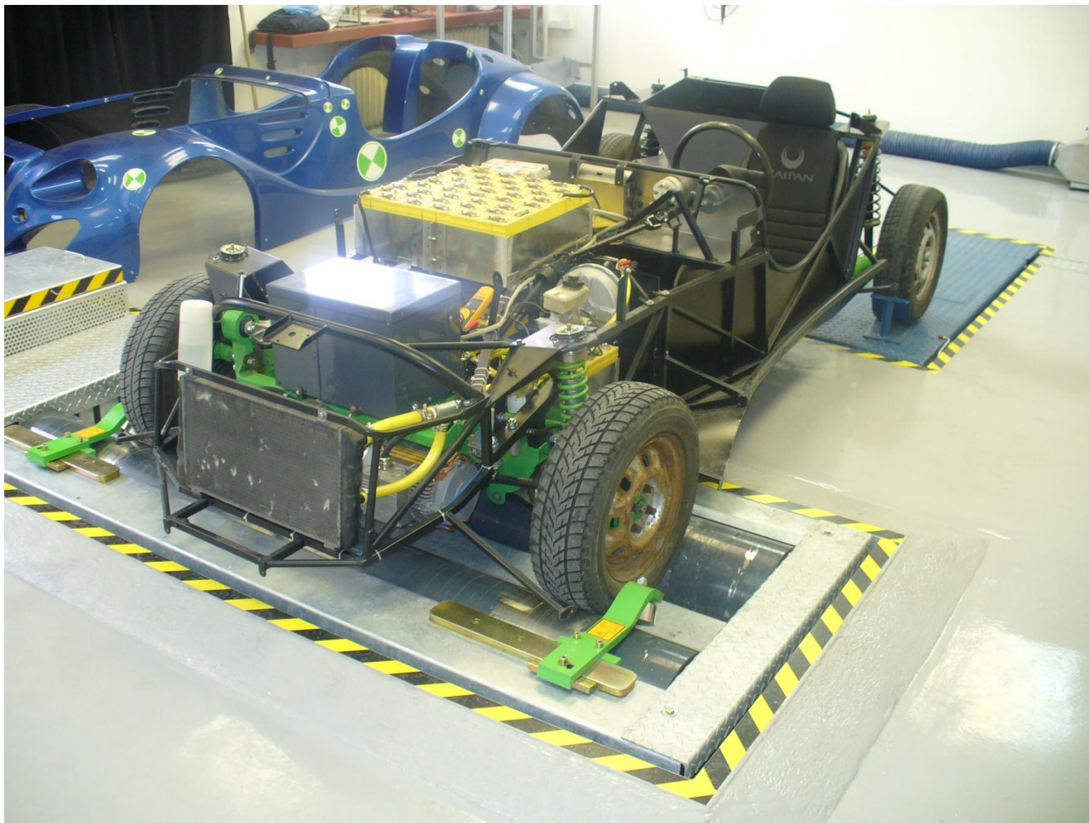
Obr. 25 Zástavba frekvenčního měniče I.generace do chassis K0, experimentální test výkonu a maximálního momentu pohonů K0 (2009/2010)
