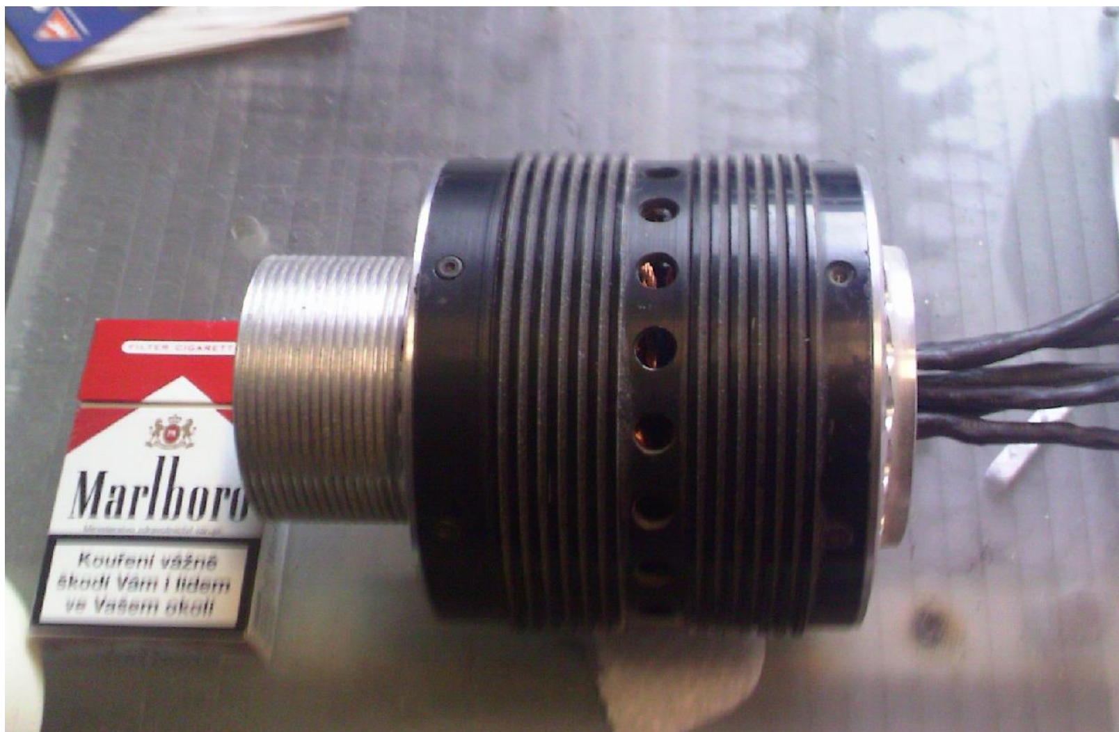
Obr. 22 Realizace BLDC elektromotoru (FreeAir) pro zástavbu do K3 s převodovkou Favorit a alternativně převodovkou AIXAM s variátorem, posléze jednotka zastavěna pro demonstrační účely do chassis AIXAM, řídicí elektronika MGM Compro, 2011)
