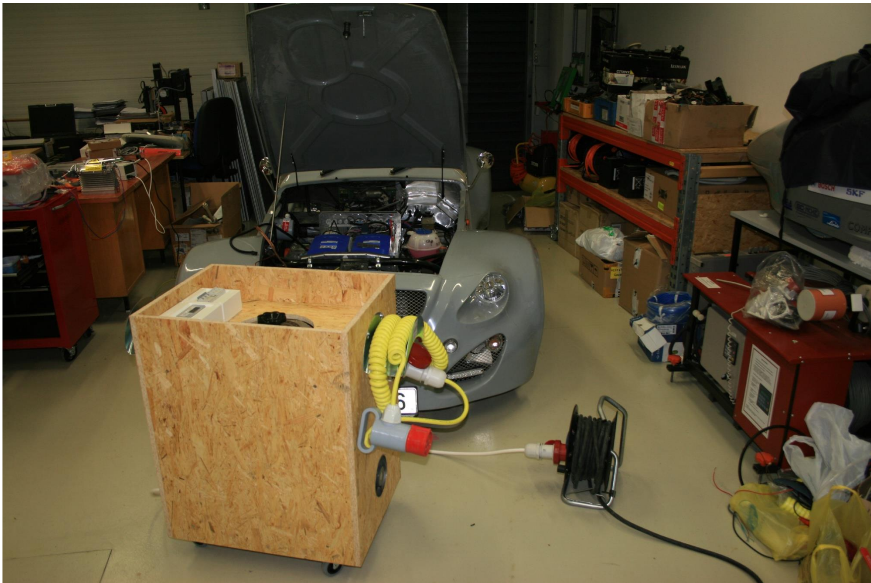
Obr. 34 Experimentální nabíjení soustavy trakčního akumulátoru K1 v laboratoři CPIT C112 (2010-2011).
