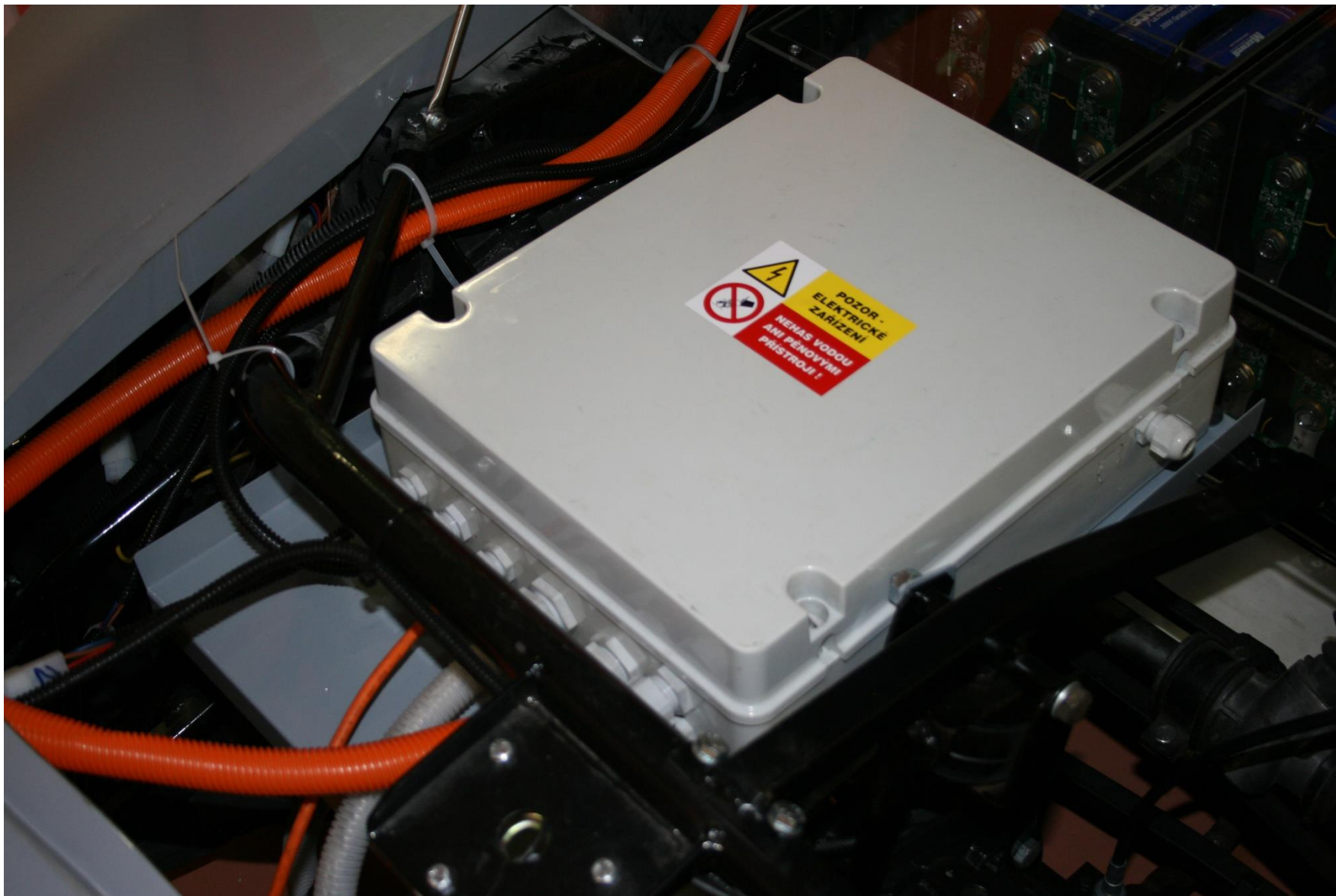
Obr. 29 Zástavba řídicí jednotky jednomotorového uspořádání se synchronním motorem v přední části K3 (TG Drives, parametrická realizace, 2012)
