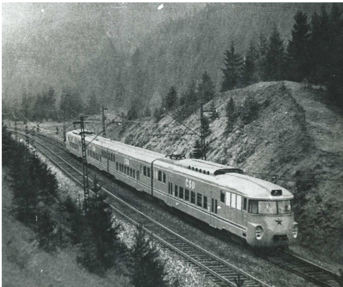
Obr. 24. Elektrická motorová jednotka pro předměstskou dopravu EM 475 – 1
